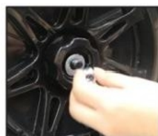
13. Postavite podlošku i ušrafite maticu
