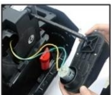
11. Nabacite elektromotor na osovinu a kablove provucite kroz rupu na telu/tijelu vozila
