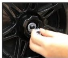
7. Postavite podlošku i ušrafite maticu
