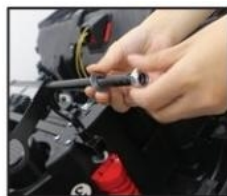
3. Skinite podloške i matice na obe strane vozila
