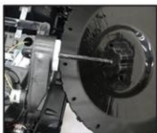
6. Nabacite točak i obratite pažnju da upadne u ležište na elektromotoru
