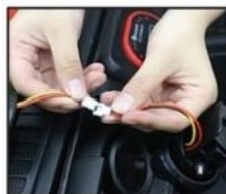
19. Povežite konektor volana sa konektorom na telu/tijelu vozila
