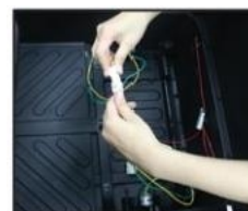
25. Povežite žice levog i desnog elektromotora
