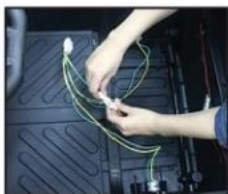
26. Povežite elektromotore na konektor/žicu na telu/tijelu vozila
