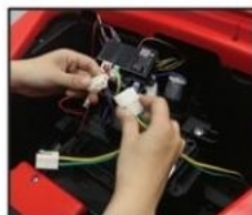
17. Povežite žice prednjeg levog i desnog elektromotora
