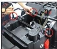
1. Poravnajte nosač sa telom/tijelom vozila i pritisnite na dole
