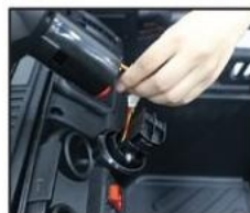
20. Uvucite žicu u telo/tijelo vozila
