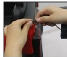
30. Povežite konektor za svetla/svjeta sa konektorom na telu/tijelu
