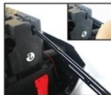
10. Provucite zadnju osovinu kroz telo/tijelo vozila i poravnajte je
