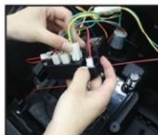
18. Povežite elektromotore na kontroler i zatvorite poklopac
