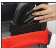
31. Namontirajte nosače za svetla/svjeta
