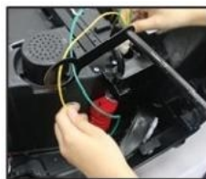
4. Provucite žice elektromotora kroz rupe na nosaču
