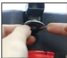
2. Nabacite podlošku i osigurač, raširite osigurač
