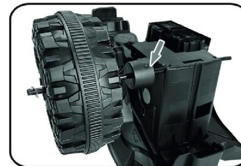
4. Provucite osovinu kroz podlošku, točak i telo/tijelo vozila
