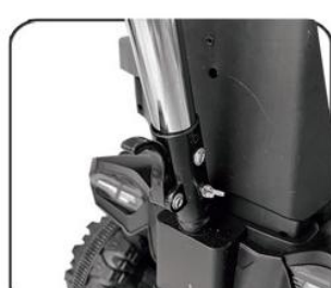
22. Ušrafite šraf i podignite ručku za zaključavanje na gore
