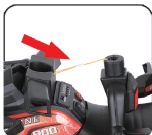
9. Povežite napajanje na volanu i iz tela/tijela vozila
