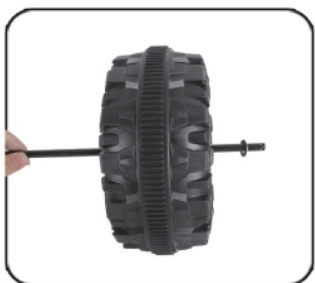
1. Nabacite zadnju osovinu na točak
