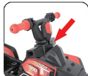
10. Provucite šraf kroz volan i osovinu i ušrafite
