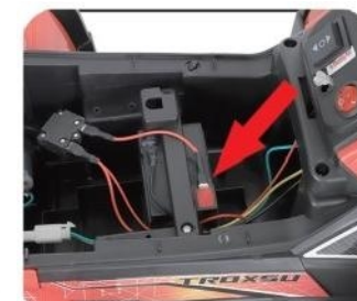
12. Sa bateriju skinite zaštitu i povežite napajanje
