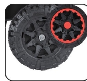
6. Nabacite podloške i osigurače, postavite ratkapne
