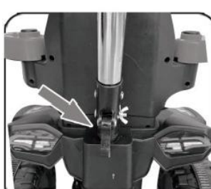
21. Nabacite ručicu za guranje na telo/tijelo vozila
