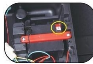
7. Povezivanje baterije – skinite belu izolacionu kapicu
