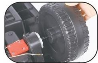
4. Montaža zadnjih točkova - Nabacite podlošku, poravnajte i nabacite točak na osovinu tako da upadne u zupčanik na motoru
