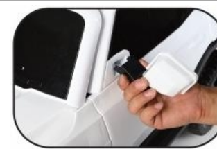
20. Montaža retrovizora – poravnajte ih sa rupama na telu/tijelu i ubacite ih
