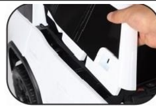
13. Nabacite levi/lijevi i desni prozor na telo/tijelo vozila
