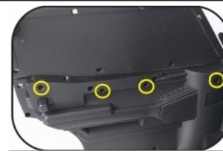
14. Ušrafite prozore kroz gore označene rupe na vratima vozila
