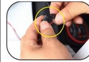
18. Montaža šoferšajbne – povežite žice sa žicama iz tela/tijela vozila
