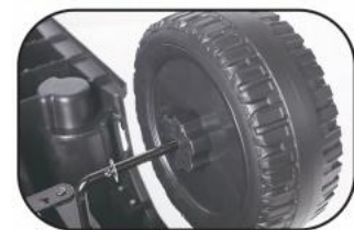
1. Montaža prednjih točkova - Nabacite podlošku, poravnajte i nabacite točak na osovinu
