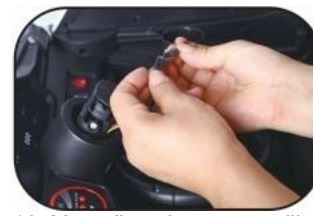
16. Montaža volana – povežite žice iz volana i sa tela/tijela vozila
