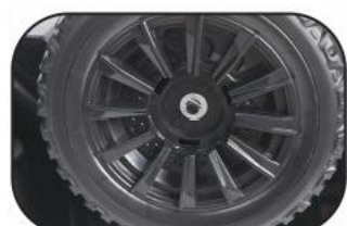
5. Nabacite podlošku, provucite i raširite osigurač kako biste fiksirali točak
