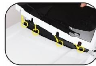
19. Poravnajte šoferšajbnu sa telom/tijelom vozila i ubacite je
