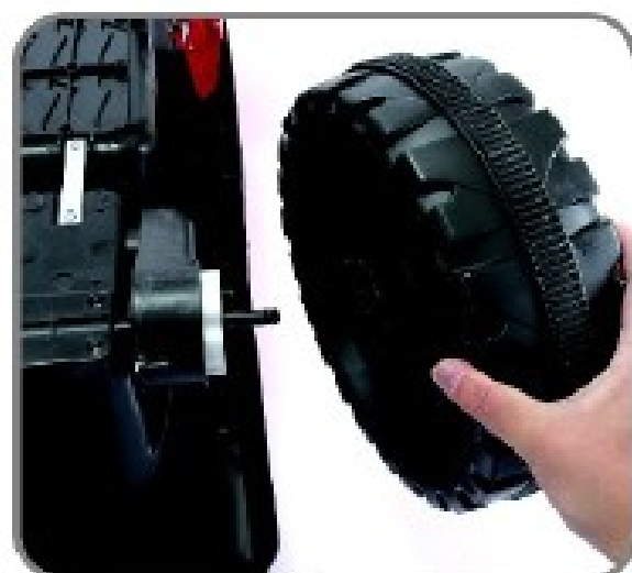
1. Na zadnje osovine nabacite točkove
