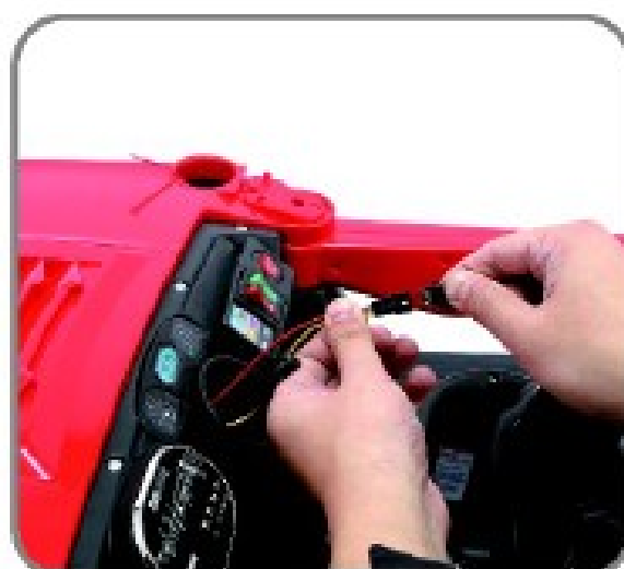
8. Povežite napajanje na volanu
