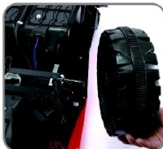
5. Na prednje osovine nabacite točkove
