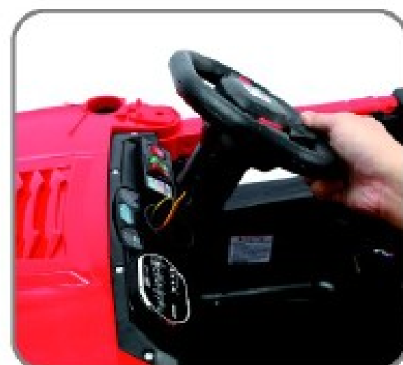
9. Nabacite volan na osovinu
