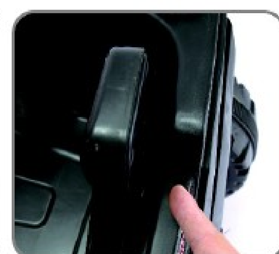
15. Ubacite nosač u rupe na zadnjem delu vozila
