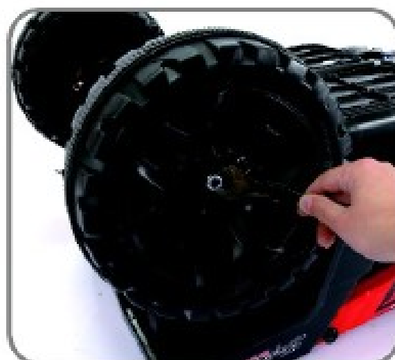
2. Dotegnite šrafove na zadnjoj osovini
