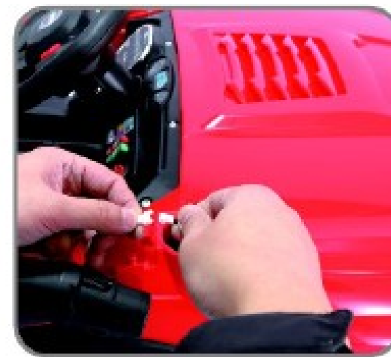
19. Povežite napajanje šoferšajbne
