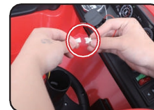
16. Povežite napajanje volana
