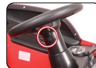
18. Ubacite volan u ležište
