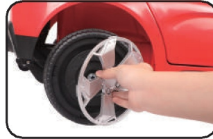
9. Nabacite ratkapne na sva 4 točka
