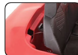
14. Ubacite sedište u ležište
