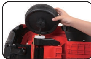
6. Ubacite zadnje točkove u njihova ležišta
